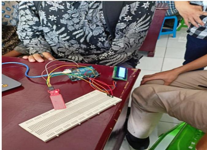
**Gambar 4. Pengujian arduino dengan menggunakan Sensor Air**
