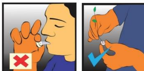
Gambar 9. Contoh perilaku yang salah dan benar dalam membersihkan komponen sprayer tersumbat
